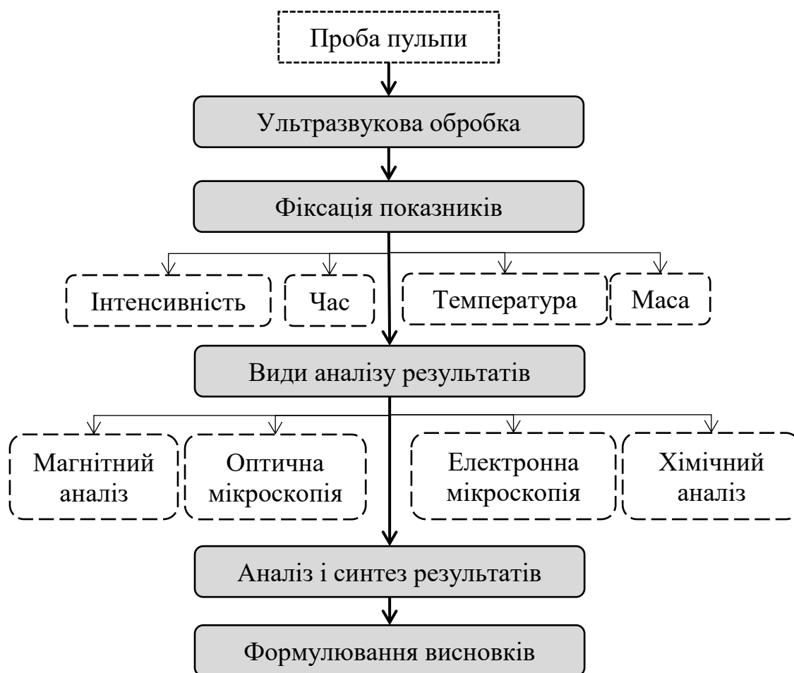
Рис. 4.2. Загальна схема проведення досліджень із ультразвукового оброблення проб
